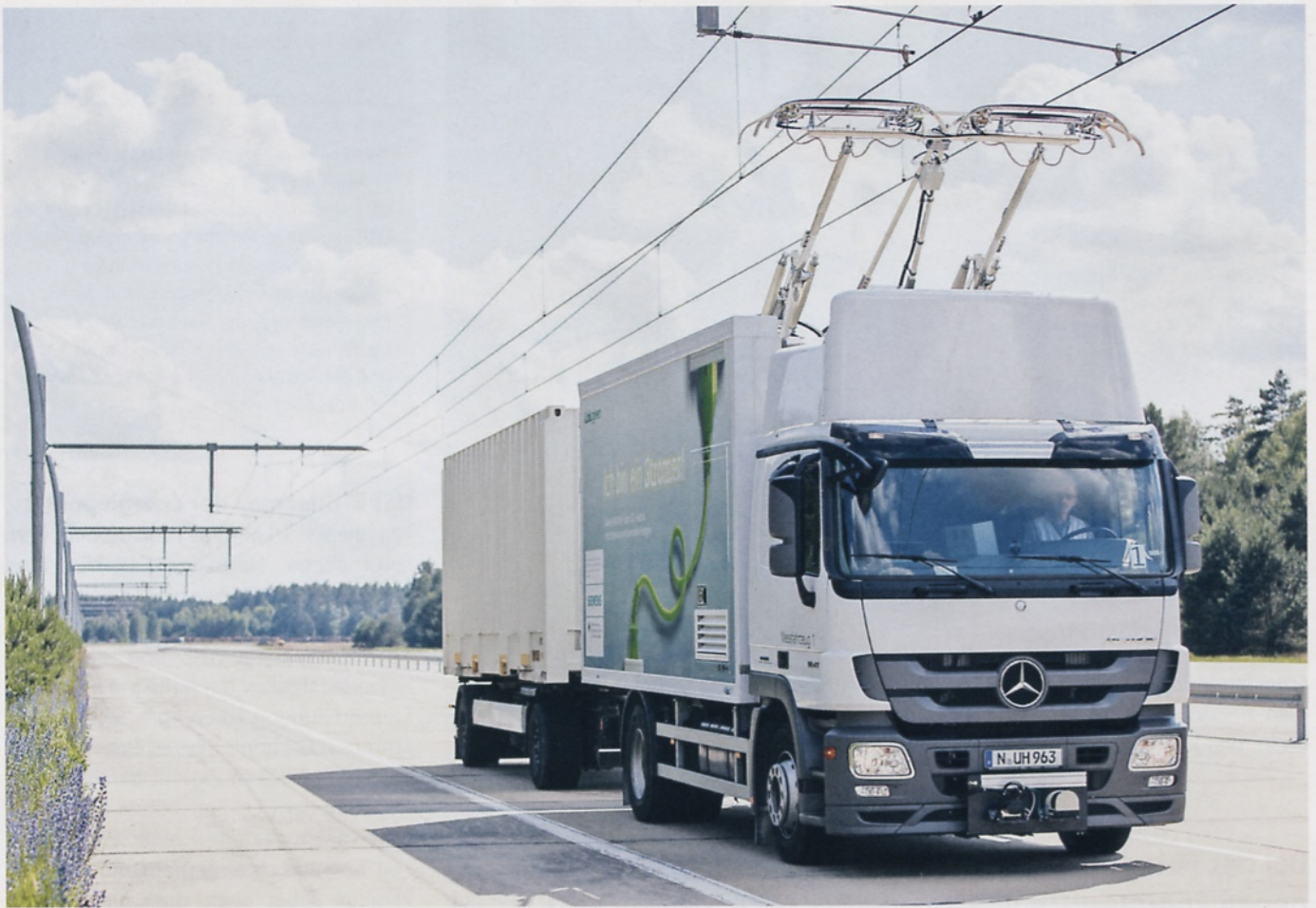
Aus heutiger Sicht ist es schwer vorstellbar, dass Elektro-LKW, versorgt über Oberleitungen, zur Normalität werden. Bild: Siemens
